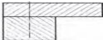
هاشور مقطع دو قطعه چوب توپر مخالف هم زده شده است
